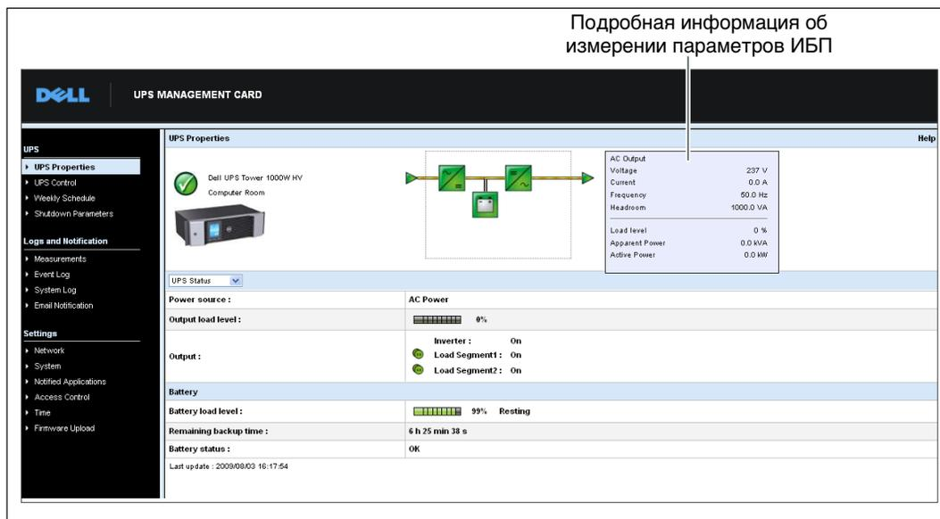
Рисунок 17. Подробная информация об измерении параметров ИБП
