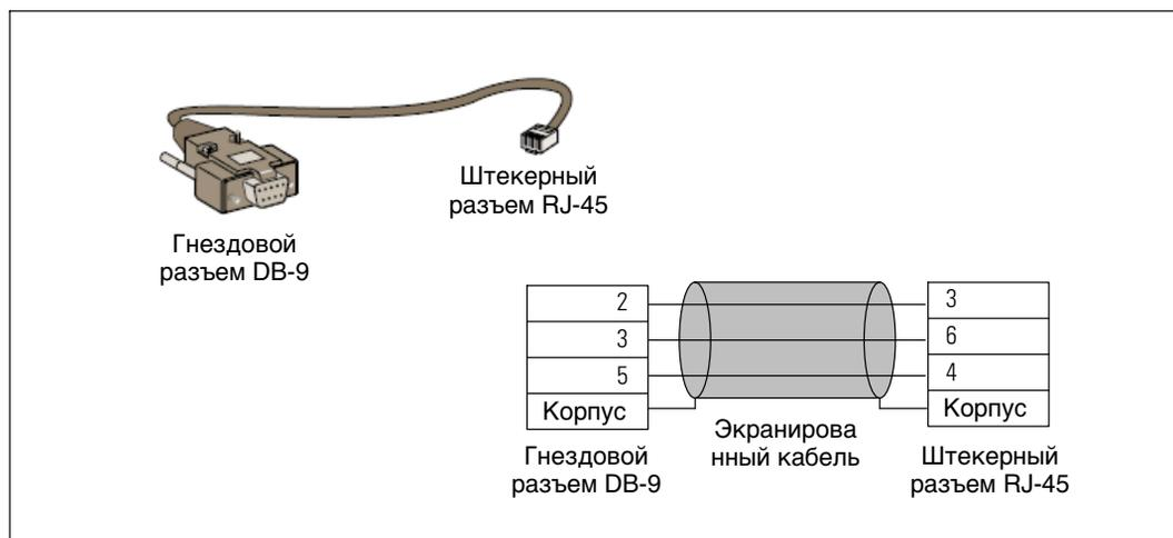
Рисунок 37. Последовательный кабель DB-9/RJ-45 и вывод
